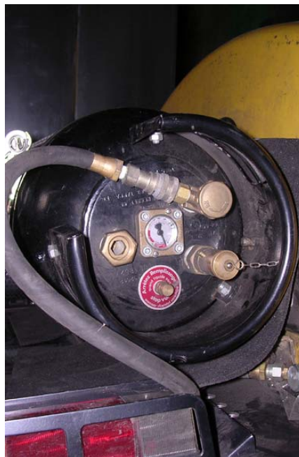
Foto 2: LPG-wisselreservoir - er zijn meerdere (minimaal twee) aansluitingen
