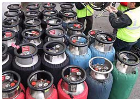
Foto 2: LPG-wisselreservoir - er zijn meerdere (minimaal twee) aansluitingen
