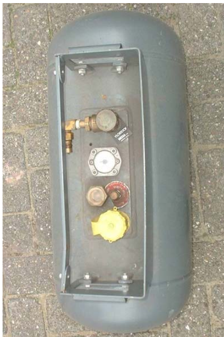
Foto 1: LPG-wisselreservoir - er zijn meerdere (minimaal twee) aansluitingen
